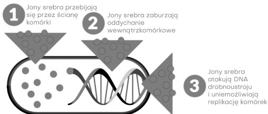
Rys.1.7: Działanie przykładowej powłoki antybakteryjnej.
